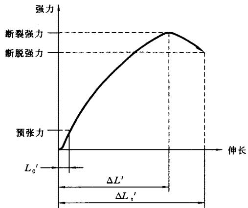
图2 松式夹持试样的拉伸曲线
