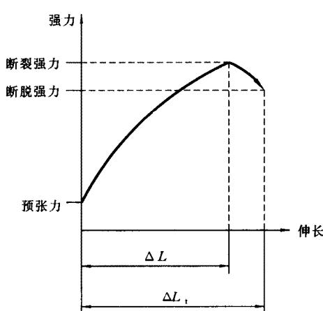
图1 预张力夹持试样的拉伸曲线
